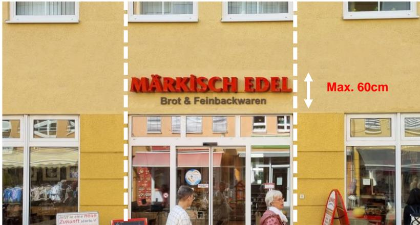
Abb. 11: Bemaßung und Ausrichtung von Werbeanlagen (Unternehmensname) in der Havelpassage
